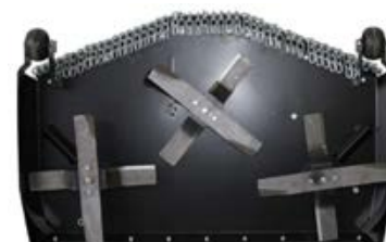
Hochgrasmäherwerk mit 6 Messern
